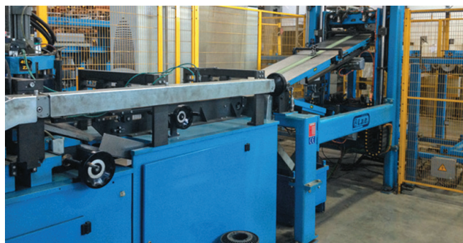
Линия по производству магнитных сердечников
