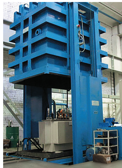
Участок заливки масла в ТМПНГ-СЭЦ
