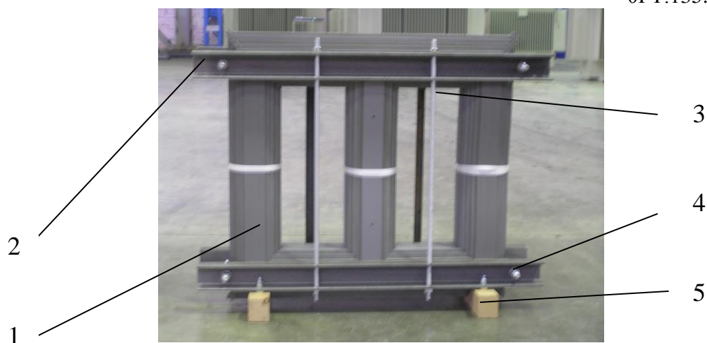
Рис. 2.2 Магнитопровод в сборе. 1 – магнитная система, 2 – прессующая балка, 3 – стяжная шпилька вертикальная, 4 – стяжная шпилька горизонтальная, 5 – ступенчатая основа
