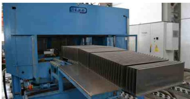
Производство корпусов трансформаторов
